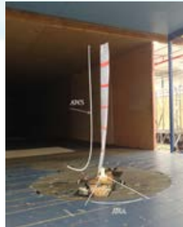
Fig 1 : Calcul IFS sur une voile « maquette » – soufflerie Auckland
